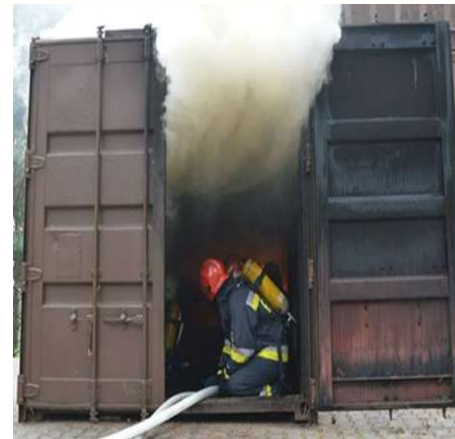
Фото 33: Нейтральна площина на висоті приблизно 1,3 м. Характеристика потоку наближена до ламінарної. Це означає, що переміщення у напрямку пожежі є безпечним, за умови охолодження продуктів згорання. У вільній від задимлення зоні наявна найкраща видимість і найнижча температура.
