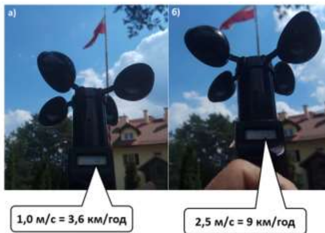
Фото 24 а–б: Порівняння інструментальних вимірювань швидкості вітру та візуальних ознак його впливу на полотнище прапора. Розбіжність даних порівняно з табличними значеннями (Табл. 1) може бути зумовлена похибкою вимірювань, різною висотою замірів або інерційністю приладу, проте загальна закономірність підтверджується. Візуальні індикатори є надійним допоміжним засобом під час проведення розвідки: вони дозволяють оперативно оцінити вітровий вплив та доповнити оперативну картину ключовою інформацією про можливу зміну динаміки пожежі.
