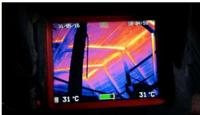
Фото 42: Зміна забарвлення на стіні виразно вказує на наявність значної кількості тепла у будівлі.
