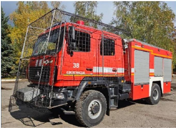
Рисунок 3.3 – Встановлення захисного металевого каркасу на пожежну автоцистерну
