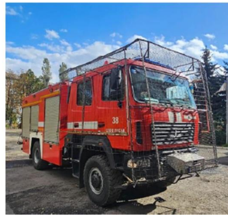
Рисунок 3.3 – Встановлення захисного металевого каркасу на пожежну автоцистерну
