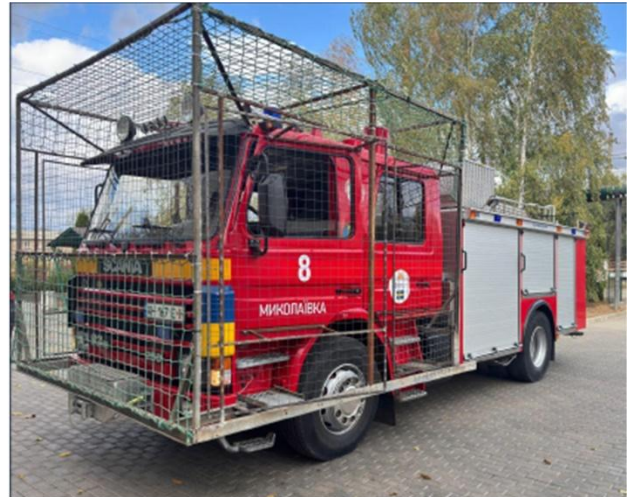
Рисунок 3.4 – Встановлення захисного металевого каркасу на пожежну автоцистерну, яка була передана підрозділам ДСНС у якості гуманітарної допомоги
