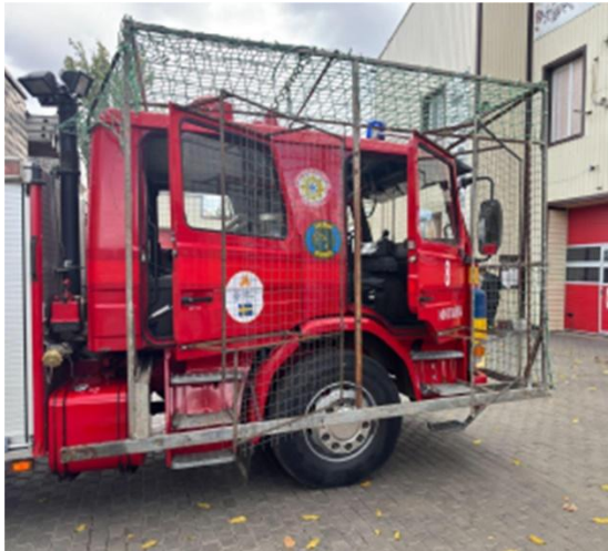
Рисунок 3.4 – Встановлення захисного металевого каркасу на пожежну автоцистерну, яка була передана підрозділам ДСНС у якості гуманітарної допомоги
